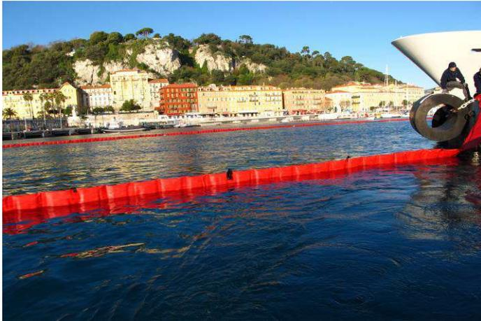
Un élément de barrage de confinement BARRACUDA est destiné à lutter contre la propagation des pollutions par hydrocarbures en zone maritime ou fluviale. Il est composé de flotteurs en plaques de mousse indépendants.
